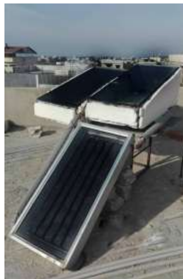
الشكل (3): المقطران الشمسيان المصنعان أحدهما مزود بلاقظ شمسي والثاني دون لاقظ شمسي
