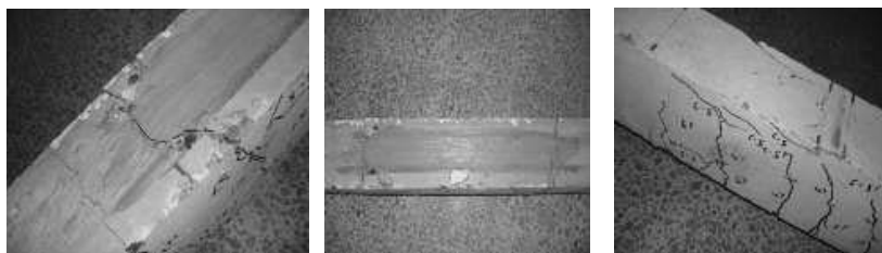
الشكل(16): انهيار الجائز B-500-1
