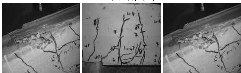
الشكل(19): انهيار الجائز B-1000-2
