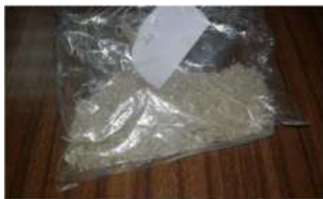
الشكل 7 الخيوط بعد تقطيعها ليعاد مزجها بالحالة المنصهرة
