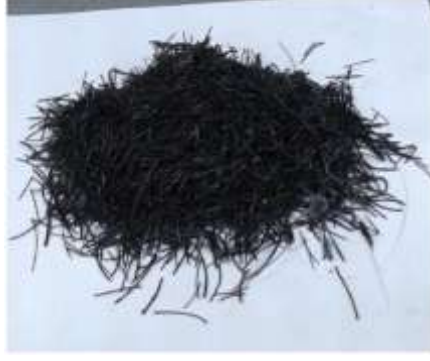
الشكل 6 خيوط المزيج ( بولي إيثيلين هباب الفحم ) المبتوقة تحضيراً لإعادة صهرها
