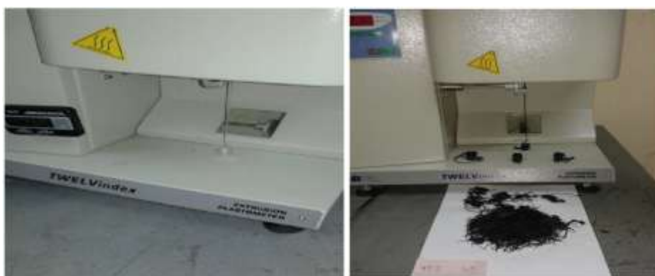
الشكل 8 إجراء اختبار السيولة للبولي إيثيلين-هباب الفحم (يمين) وللبولي إيثيلين-كربونات الكالسيوم (يسار)
