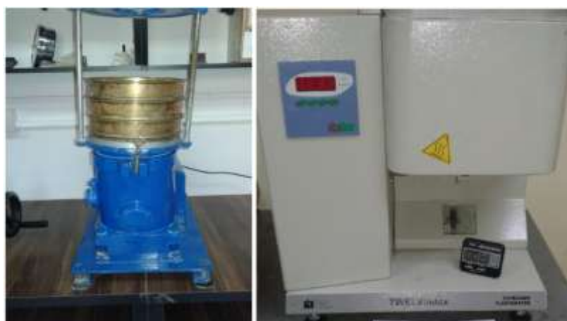
الشكل 5 جهاز اختبار السيولة (يمين) وجهاز التنخيل الالي (يسار)
