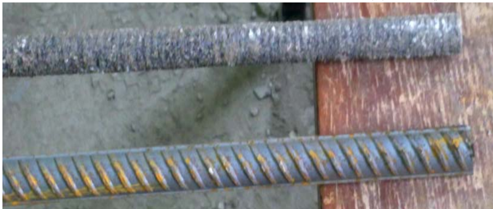
الشكل (3) شكل قضبان التسليح الفولاذية والكربونية CFRP بقطر 12 ملم
