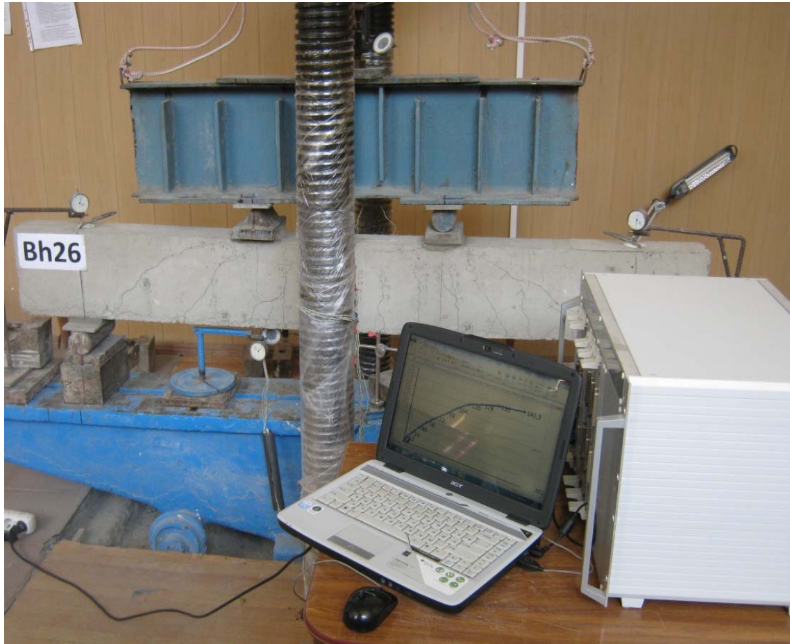
الشكل (7) شكل جهاز التحميل ومحطة قياس التشوهات طراز (Ostroestva izmeritelna-Obravlaushe OIO2002) المستخدمة في اختبار الجوائز في جامعة روستوف الحكومية في روسيا.
