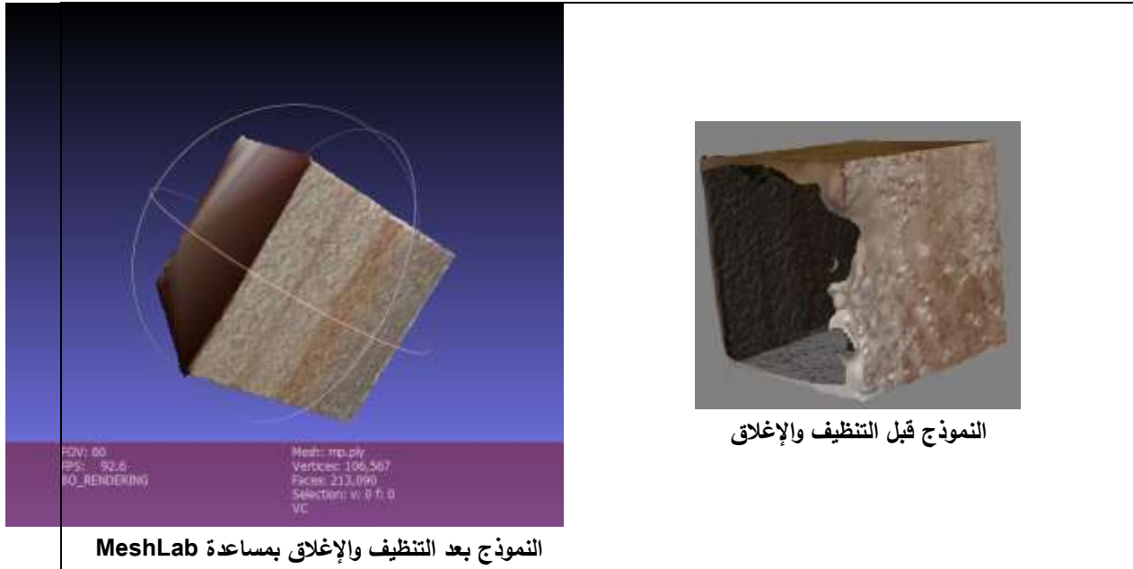
الشكل (6). معالجة النموذج الشبكي لعنصر الاختبار المنتظم داخل MeshLab.
