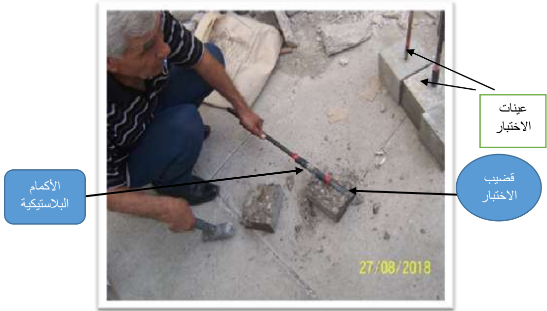
الشكل (6) : طول إرساء القضيب الفولاذي ضمن عينة الاختبار المكعبية
