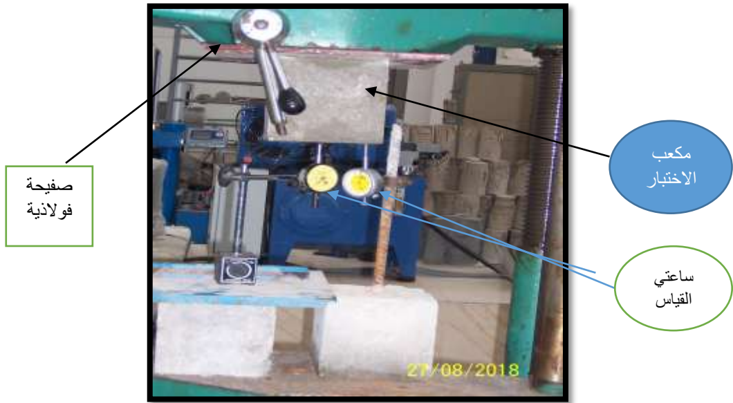
الشكل ( 7 ) : يبين آلية إعداد اختبارات الشد على جهاز شد الحديد لعينات الاختبار
