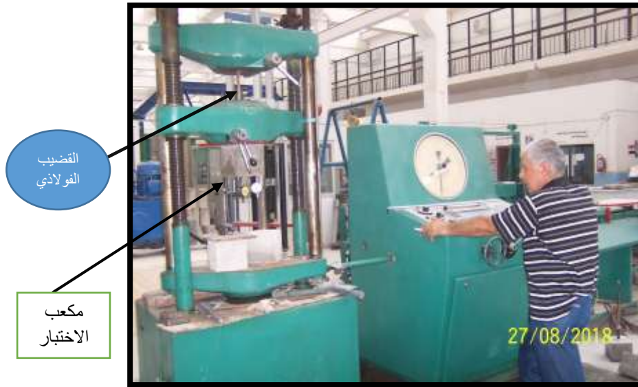
الشكل ( 8 ) : كيفية شد قضبان التسليح الفولاذية لعينات الاختبار في جهاز اختبار شد الحديد
