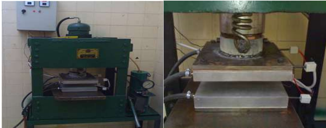
الشكل (2) مكبس تشكيل نصف هيدروليكي
