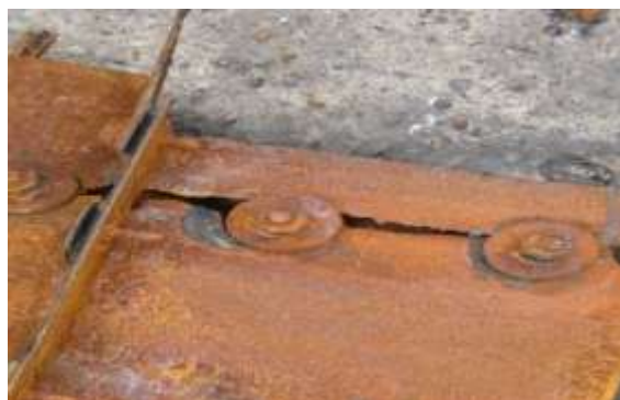
الشكل (9): مظهر التآكل التشققي حول البراغي المثبتة للصينية المنهارة رقم (33).
