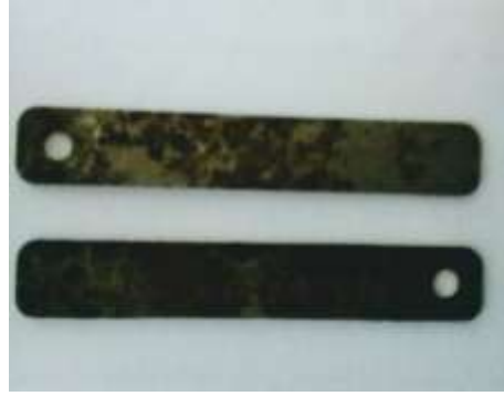
الشكل (7): مظهر التآكل في الكوبونين.
