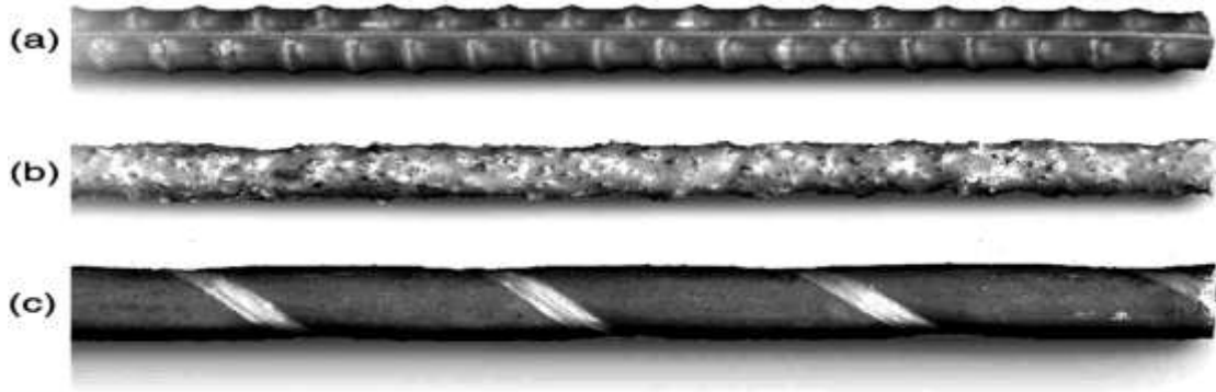
الشكل (1): الأشكال المختلفة لقضبان الـ FRP. (a) مضلعة; (b) مملوءة ومكسوة بالرمل; (c) ملفوفة ومكسوة بالرمل.
