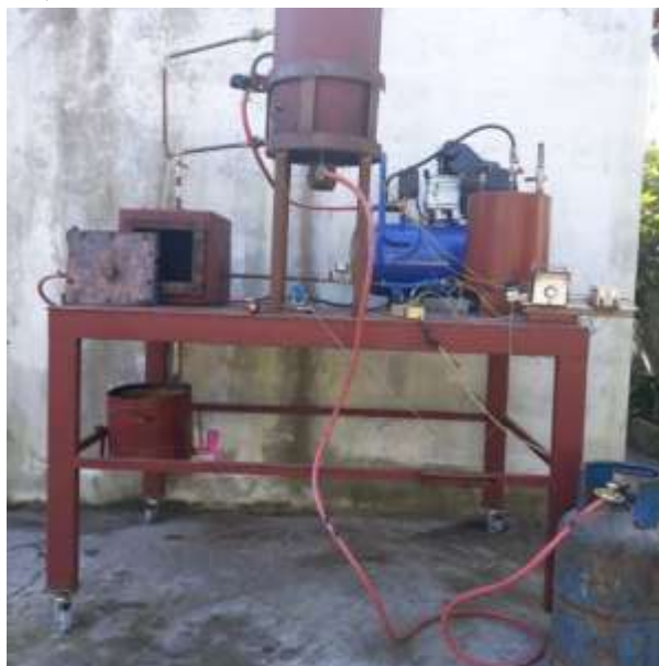
الشكل (2) الجهاز المصنع من قبلي لإنتاج الإسفلت الرغوي
