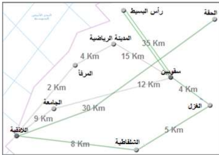
الشكل (2): مخطط شبكة الطاقة العاملة بتوتر اسمي 66 Kv في محافظة اللاذقية.*
