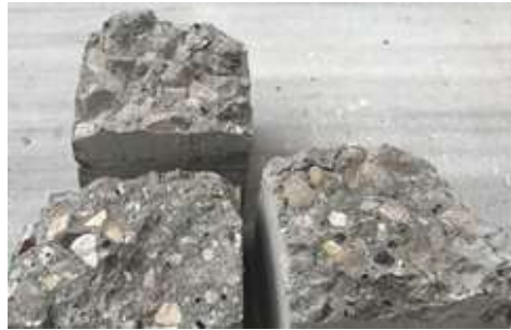
الشكل (8): العينات المكعبية المحضرة من الكتل البيتونية للمبنى المهدم
