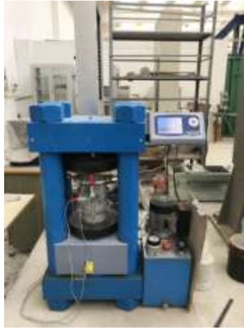
الشكل (12): جهاز اختبار العينات البيتونية على الضغط البسيط - رسم منحنى (إجهاد - تشوه)
