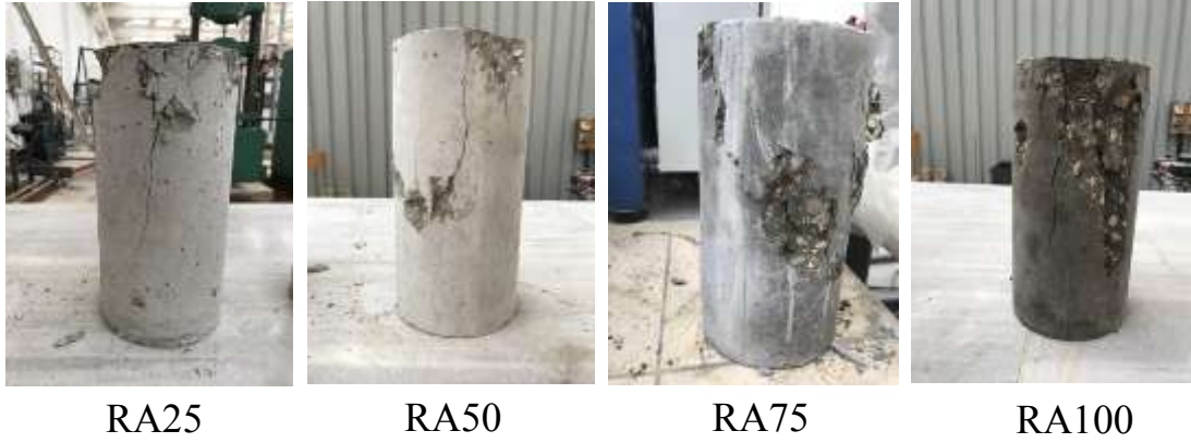
الشكل(18): أنماط الانهيار للبيتون المعاد تدويره مقارنة مع البيتون الطبيعي
