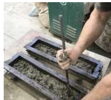
الشكل (10) : دك الخلطة البيتونية بواسطة قضيب معدني
