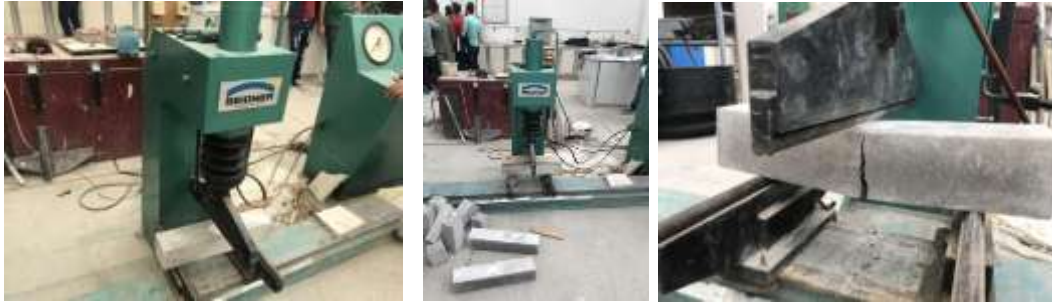
الشكل (21) : اختبار العينات على الشد بالانعطاف
