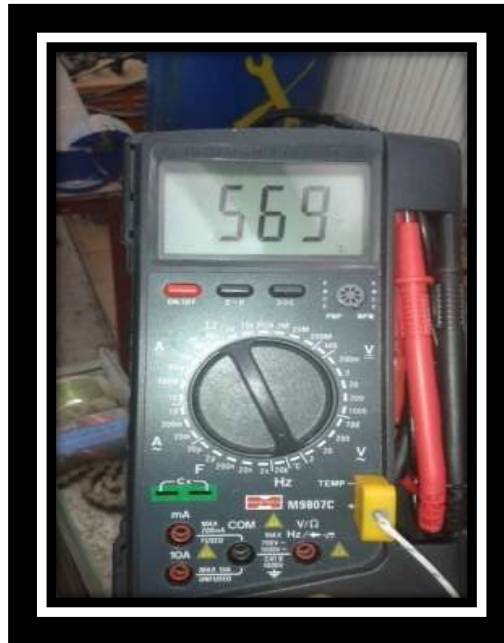
الشكل (7) مقياس درجة الحرارة لقياس الحرارة داخل الفرن
