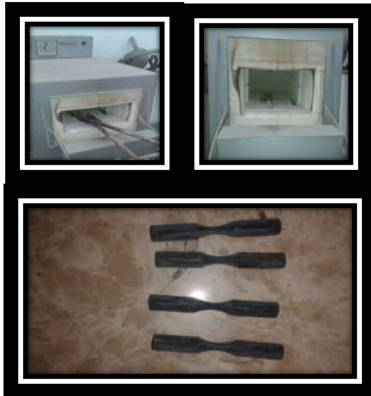
الشكل (6) عينات الفولاذ بعد المعالجة الحرارية
