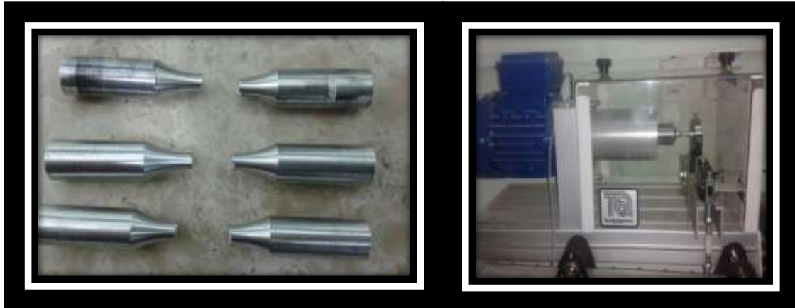
الشكل (12) عينات فولاذ منخفضة الكربون بعد الكسر
