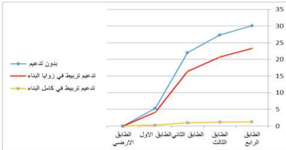
الشكل (11) قيم الانتقالات الطائفية في مجال الزمن للزلزال NORTHTRIDGE في حالة التقييس time domain max
