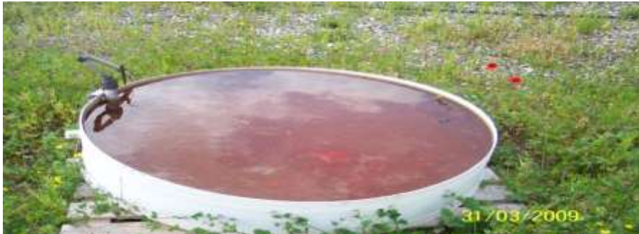
الشكل (7) حوض التبخر في سد 16 تشرين المستخدم في تجارب البحث
