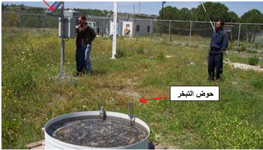
الشكل (9) حوض التبخر المستخدم في التجربة والمحطة المناخية المجاورة له في منطقة البحث
