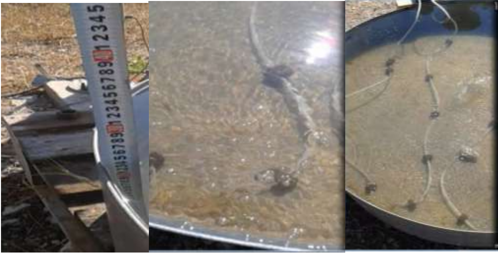
الشكل (12) تشكل الفقاعات وصعودها للسطح وكيفية أخذ القياسات
