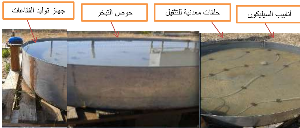
الشكل (11) تجهيز الحوض للتجربة ووضع الأدوات اللازمة
