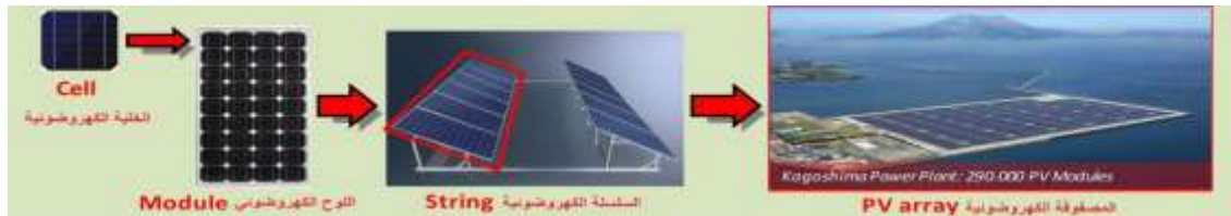
الشكل (3) بنية مصفوفة كهروضوئية نموذجية [29].
