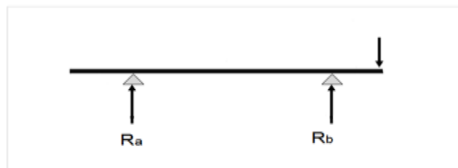
الشكل (6): القوى القطرية المؤثرة في محلي الجهاز
