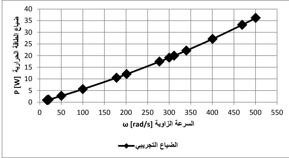
الشكل (13): تغير ضياع الطاقة الحرارية في المحملين كتابع للسرعة الزاوية
