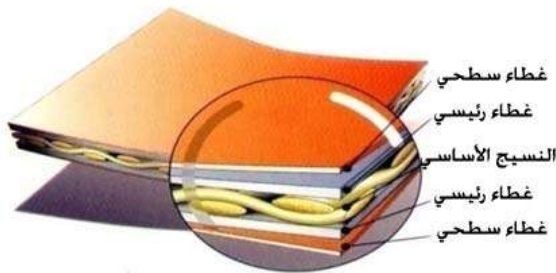
الشكل (10) طبقات مادة ETFE [11]
