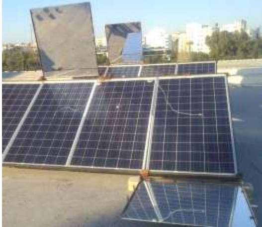
الشكل (1) الألواح الشمسية مع العواكس المسطحة وأجهزة القياس المستخدمة في التجارب.
