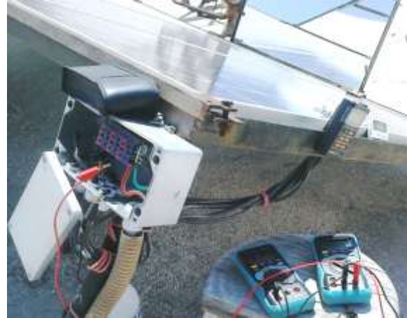
الشكل (1) الألواح الشمسية مع العواكس المسطحة وأجهزة القياس المستخدمة في التجارب.
