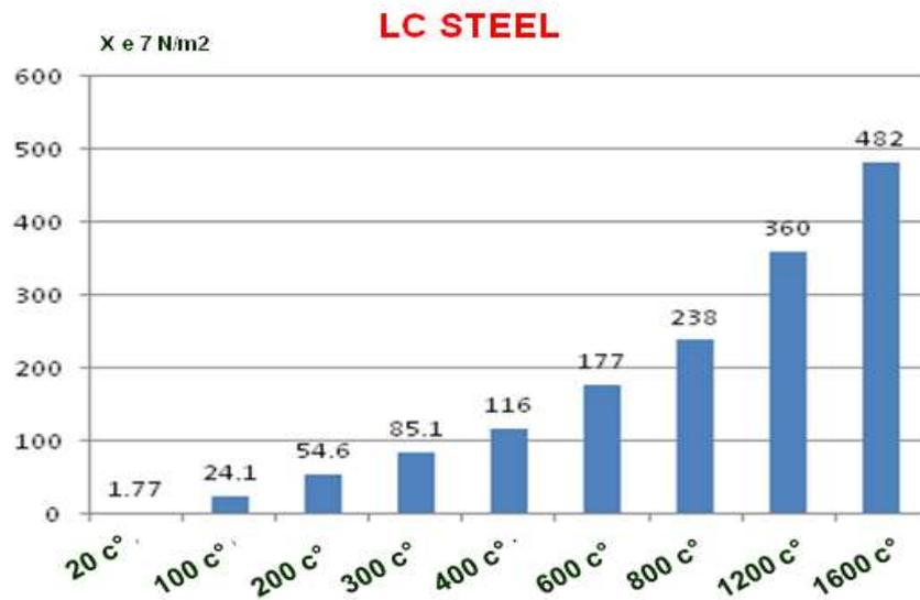
الشكل 7: قيم الإجهادات الناشئة في الوصلة عند درجات حرارة متزايدة للمادة LC Steel
