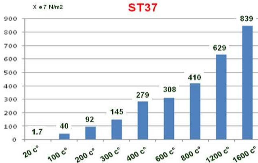
الشكل 11: قيم الإجهادات الناشئة في الوصلة عند درجات حرارة متزايدة للمادة ST37
