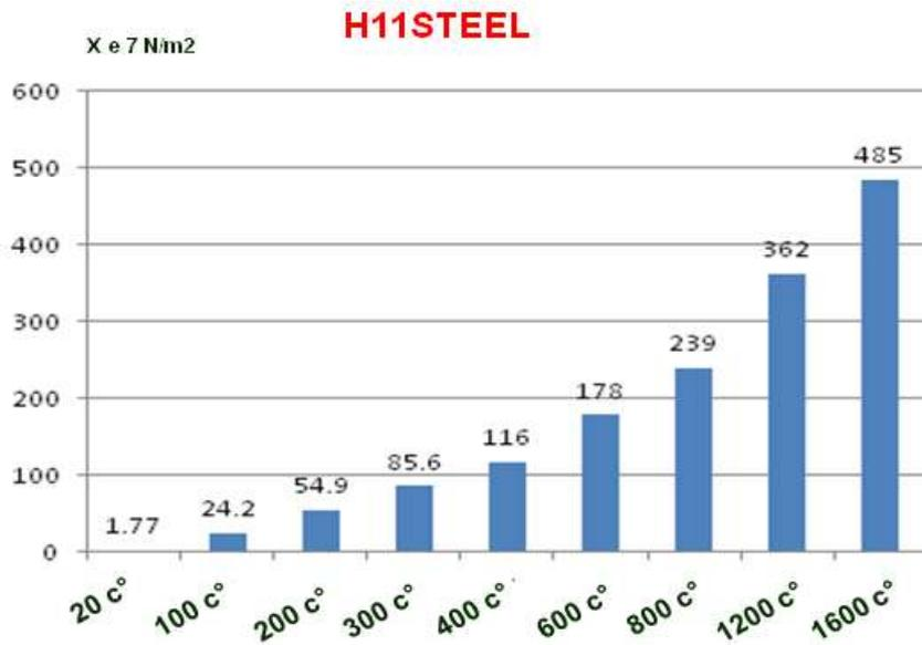
الشكل 5 : قيم الإجهادات الناشئة في الوصلة عند درجات حرارة متزايدة للمادة H11 Steel
