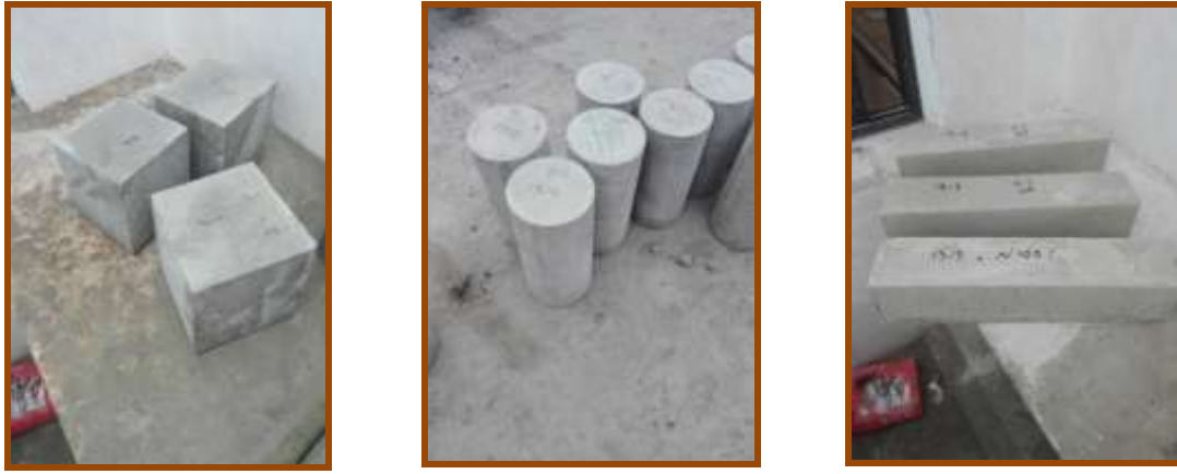
الشكل (3): نماذج من البيتون المرصوص المصنَّع (مواشير، أسطوانات، مكعبات)
