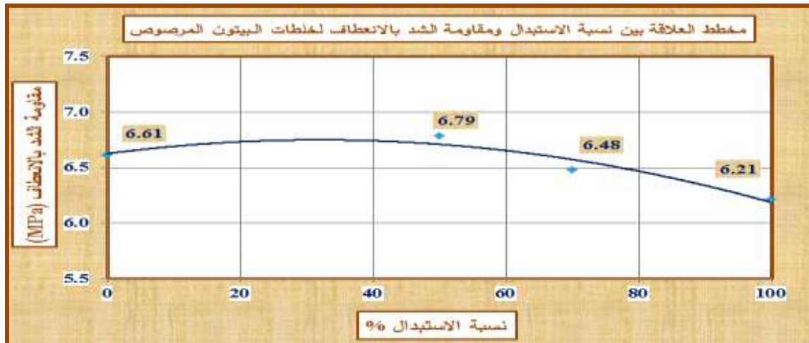
الشكل (5): منحنى العلاقة بين نسب استعمال الحصىات المعاد تدويرها ومقاومة البيتون المرصوص على الشد بالانعطاف
