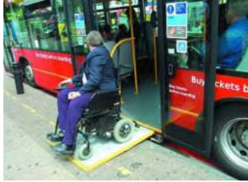
الشكل (13) تزويد الحافلة برامب لتسهيل حركة ذوي الاحتياجات الخاصة [1]
