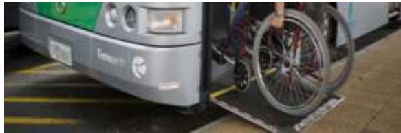
الشكل (16) تزويد الحافلات ببرامبات تساعد على حركة الصعود والنزول لذوي الاحتياجات الخاصة [10]
