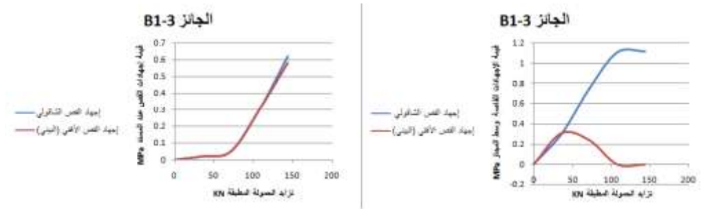
الشكل (18): تغير الإجهادات القاصة الأفقية والشاقولية مع تزايد الحمولة للجائز B1-3 a- عند المسند b- وسط المجاز
