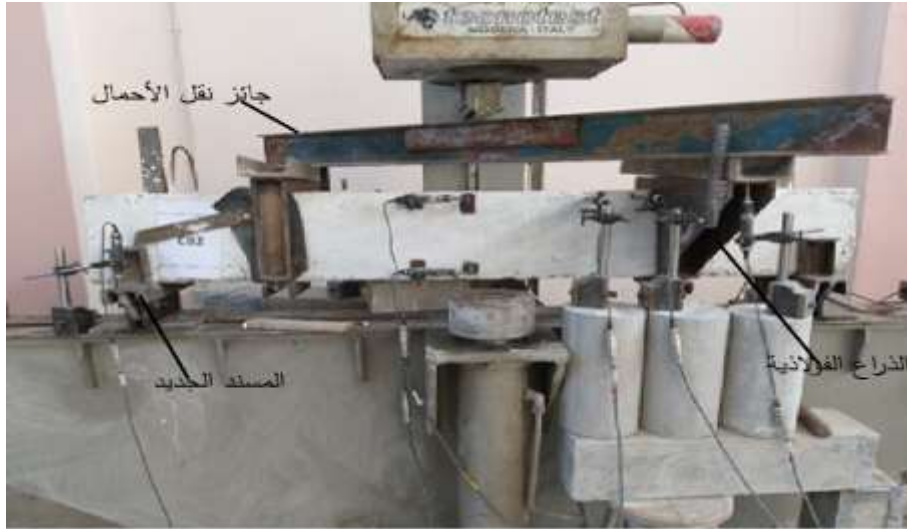
الشكل (2) جهاز التحميل المعدل لاختبار الجوائز البيتونية المسلحة تحت تأثير الفعل المركب للفتل والانعطاف
