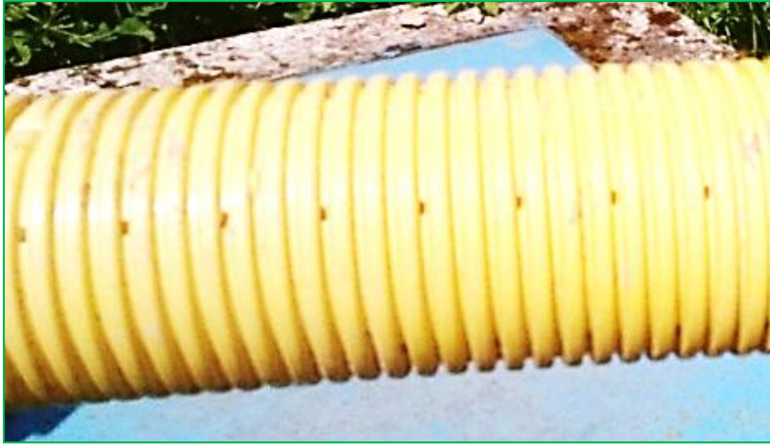
(الشكل - 8). أنابيب الصرف المستخدمة في محطة ستخريس.
