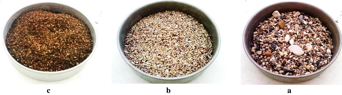
(الشكل- 2). العينات المأخوذة كفلتر في الدراسة، (a) البحص البحري الخشن، (b) البحص البحري الناعم، (c) عرجوم الزيتون.
