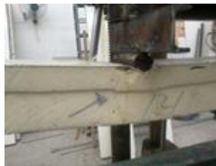
d: صورة لعينة تظهر التشوه الموضعي الحاصل عند حدوث الانهيار مع انفصال لمادة النواة
