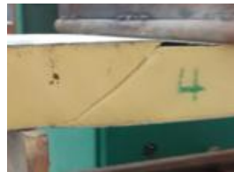
c: انهيار قصي للنواة بزواوية 45 درجة
