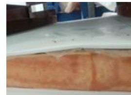
a: صورة لعينة توضح انفصال طبقة التغطية بين نقطتي تطبيق الحمولة
