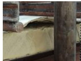
b: صورة لعينة توضح تمزق النواة وانفصال طبقة التغطية بين نقطتي تطبيق الحمولة
