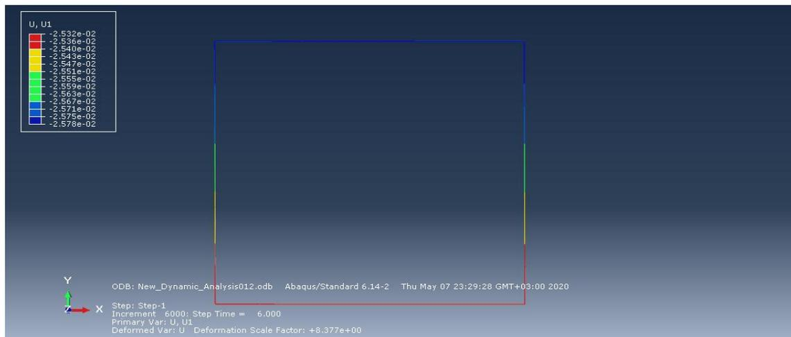
الشكل رقم (5) الانتقالات الأفقية في قشرة النفق نتيجة الحركة الزلزالية
