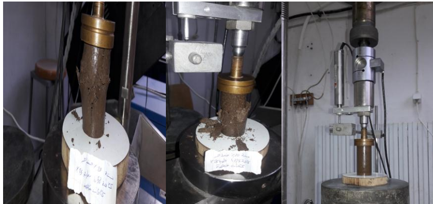
الشكل (6) صور لبعض عينات تجارب الضغط الحر.
