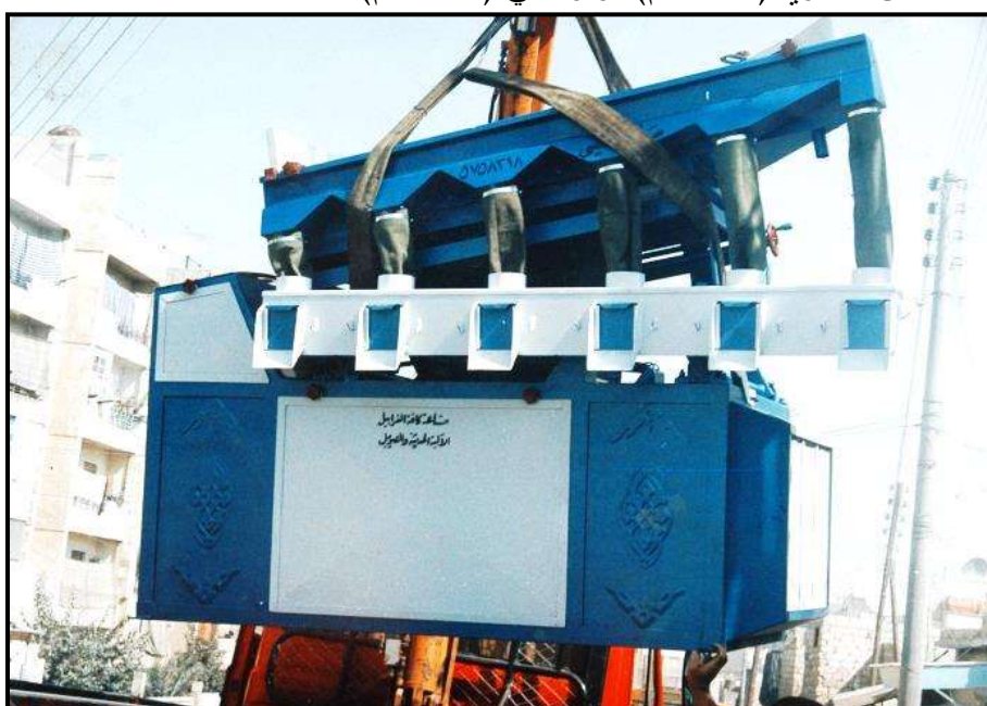
الشكل (5): الناثر (جهاز الفرز والفصل) ويدعى بالقطاعة.
