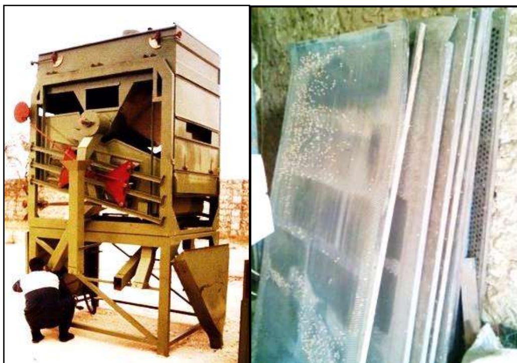
الشكل (1): الآلة مع الجزء الفعال فيها وهو الهزاز الذي يتكون من ثلاث طبقات (غرابيل).
