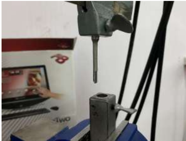
الشكل (7) يوضح الفك السفلي مع القاعدة التي صممت خصوصاً للدراسة والشفرة المعدنية المثبتة على الفك العلوي.
