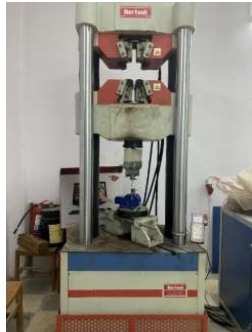
الشكل (6) يوضح آلة الاختبارات العامة المستخدمة في قياس قوة القص.
