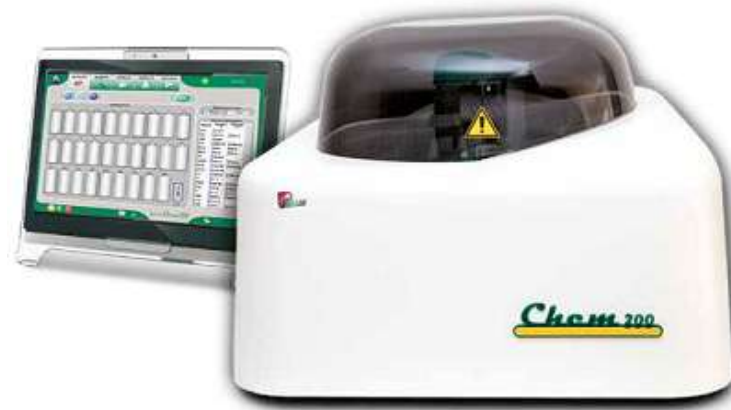
صورة(1) جهاز المقايسة المناعية الانزيمية المتجانسة
