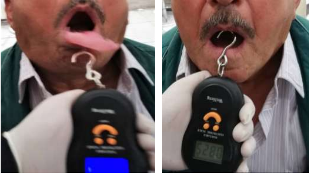
الشكل 10: طريقة قياس ثبات قواعد الأجهزة باستخدام مقياس قوة الشد الرقمي
