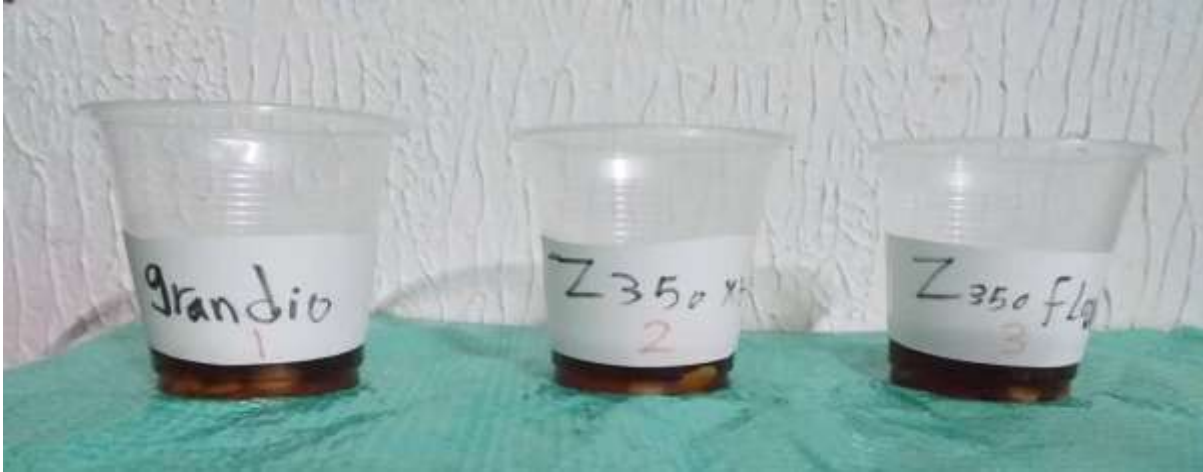
صورة (6): استخدام محلول الكولا من أجل غمر عينات الكمبوزيت
