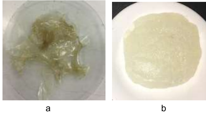
الشكل (4): البكتين المستخلص من الفالنسيا a . بكتين مجفف بالهواء، b . بكتين مستخلص قبل التجفيف
