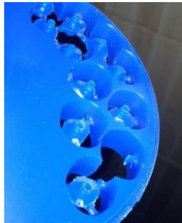
الشكل رقم (1) طريقة صنع الدعامة بطريقة الشمع الضائع
