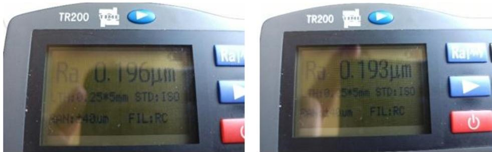
قياس العينات على جهاز مقياس خشونة السطح
