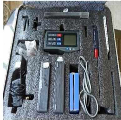
جهاز قياس خشونة السطح المستخدم في البحث
