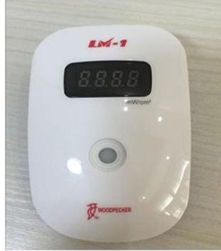
جهاز قياس شدة جهاز التصليب المستخدم في البحث
