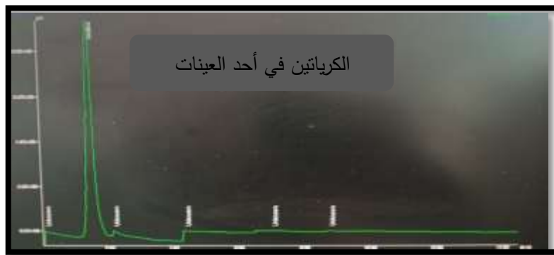
الشكل (2) يوضح كروماتوغرام محلول أحد العينات المدروسة بعد حقنه في جهاز HPLC
