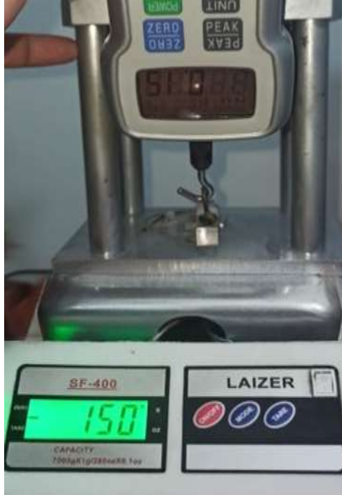
الشكل رقم (4): قراءة لمعايرة جهاز التجربة مع جهاز له موثوقية جيدة حيث نلاحظ تطابق النتيجة 150 غ
