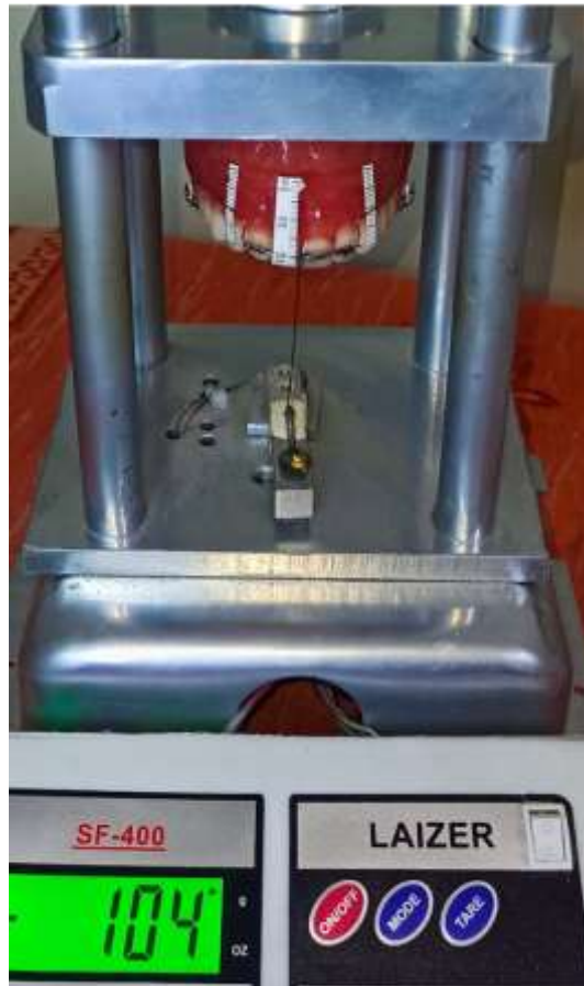
الشكل رقم (7): ربط قوس الغرز المفيد المنشط بالخطاف الموصول بالحساس وقياس قوى الغرز الناتجة
