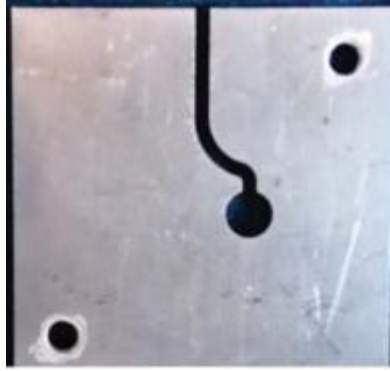
الشكل (2) القناة الصناعية في مكعب الستانلس ستيل
