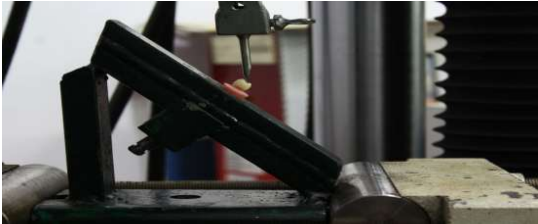
صورة توضح تطبيق القوى المائلة بزواوية 45 درجة على عينة بواسطة آلة الاختبارات الميكانيكية العامة
