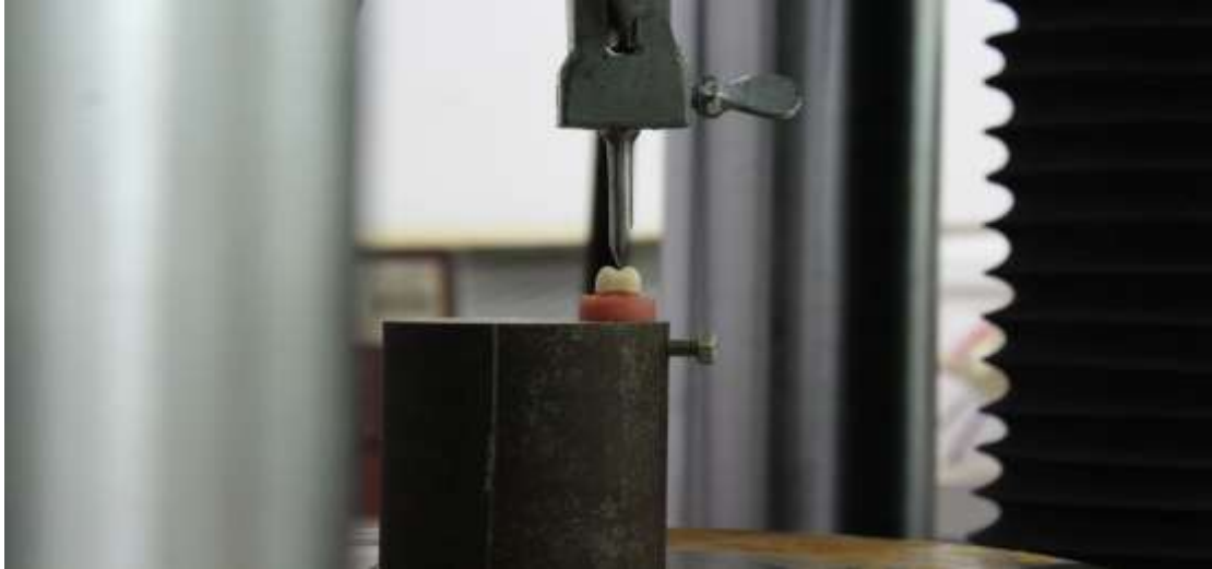
صورة توضح تطبيق القوى العمودية بزوايا 90 درجة على عينة بواسطة آلة الاختبارات الميكانيكية العامة
