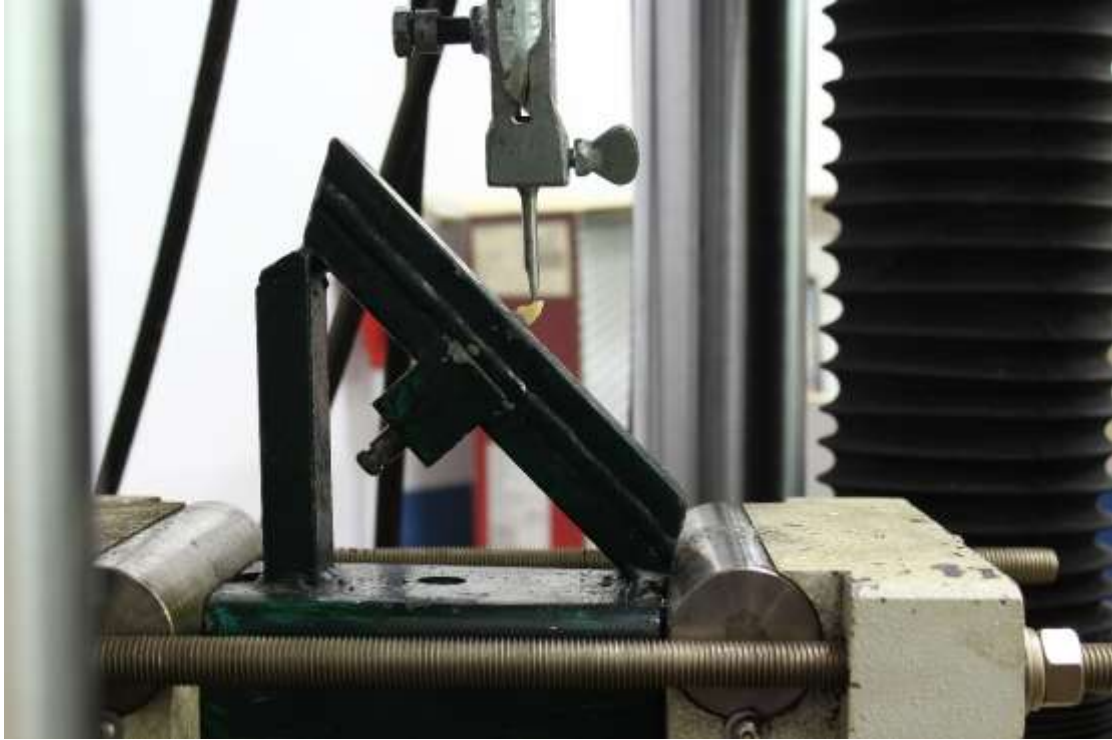
الشكل (4) تطبيق قوى مائلة بزاوية 45° على السطح الحنكي للتاج المؤقت للثنية العلوية اليمنى (عند التقاء الثلث المتوسط مع الثلث القاطع) باستخدام آلة الاختبارات الميكانيكية العامة Universal testing machine
