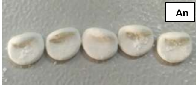
الشكل (3): مظهر مضغوطات الأسبرين العائدة إلى الشركة An بعد إجراء فحص القساوة.
