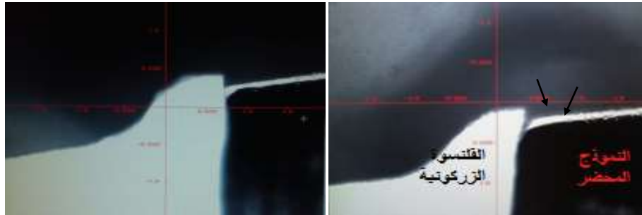
الشكل رقم 8 : يظهر الانطباق التام ما بين القلنسوة الزركونية والحافة العنقية على السطح الوحشي للعينة الثالثة
