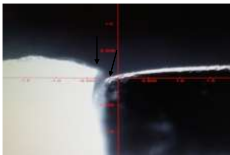
الشكل رقم 12: يظهر إحدى القيم العليا للفرجة الحفافية على السطح الوحشي للعيونة التاسعة
