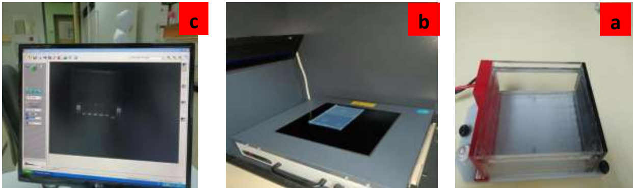
الشكل (3): (a) - هلام الآغروز بعد تعبئة العينات في الآبار وبدء الترحيل ، (b) - حجرة UV المستخدمة لإظهار العصابات، (c) - برنامج تصوير الهلام على الكمبيوتر يظهر العصابات المتشكلة
