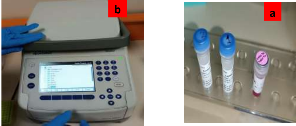
الشكل (2): (a) - العتيدة 2X ViRed Taq Master Mix و المشرعين الأمامي 1 والعكسي 2 ، (b) - جهاز الدوار الحراري Eppendorf Nexus GSX1 thermocycler .
