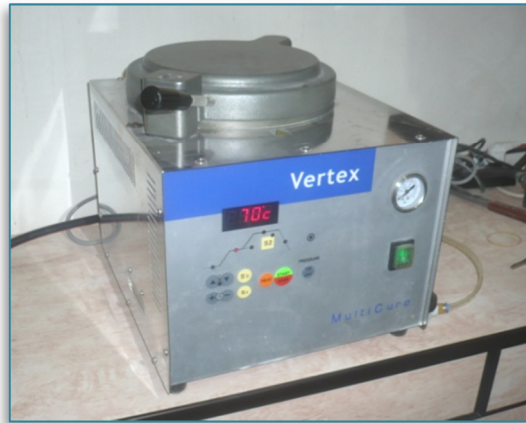
الشكل (4): يبين جهاز تصليب الأكريل MultiCure القابل للبرمجة مسبقاً
