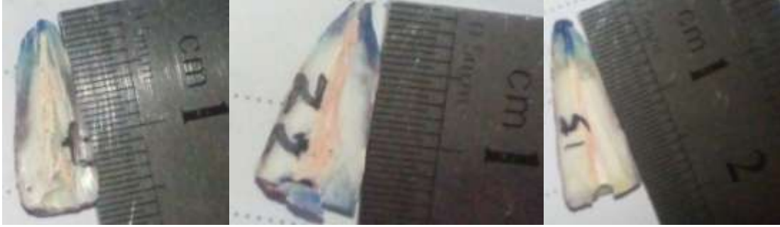
الشكل (4) عينة من أكسيد الزنك والأوجينول (تسرب 1)، Apexit plus (تسرب 3.5)، Adseal (تسرب 4) على التوالي.
