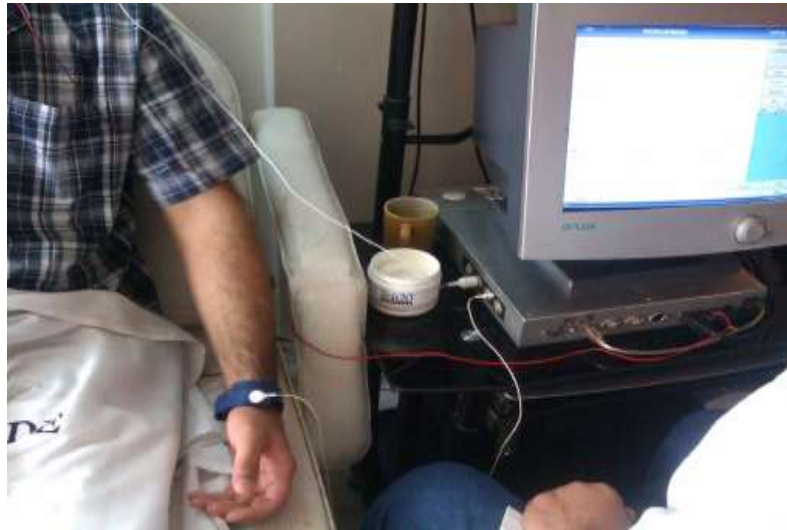
رسم توضيحي شكل (6) جهاز EMG: يوضح وضع تجهيزات مرافقة موصولة بجهاز الكمبيوتر كالمؤرض بمعصم اليد و الالكترودات
