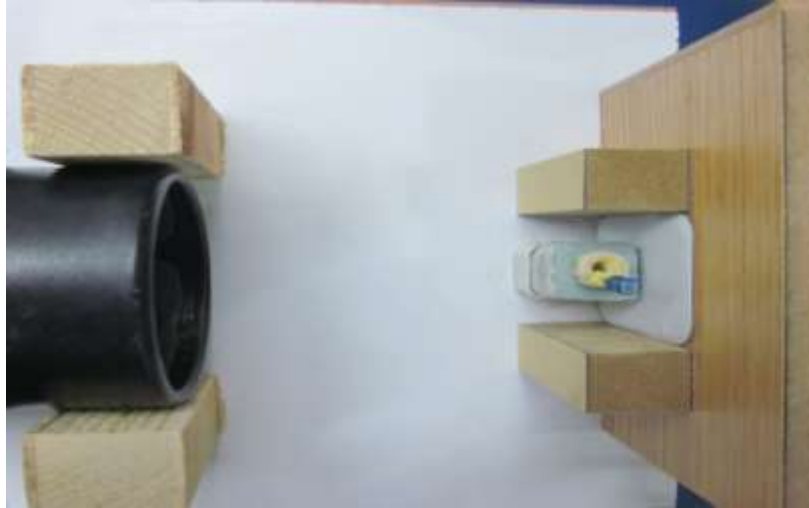
الشكل (2) يوضح تقنية التصوير الشعاعي المطبقة في البحث
