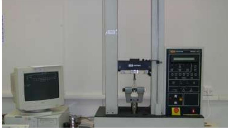
الشكل 1: صورة تبين جهاز الاختبار الأنسترون مع عينة اختبار.
