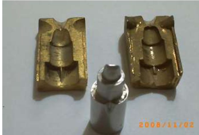
الشكل رقم 2: القالب النحاسي المستخدم للحصول على نماذج شمعية متساوية السماكة (كتف)
