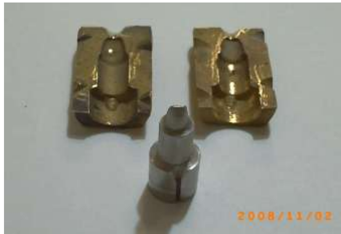
الشكل رقم 3: القالب النحاسي المستخدم للحصول على نماذج شمعية متساوية السماكة (شبه كتف)
